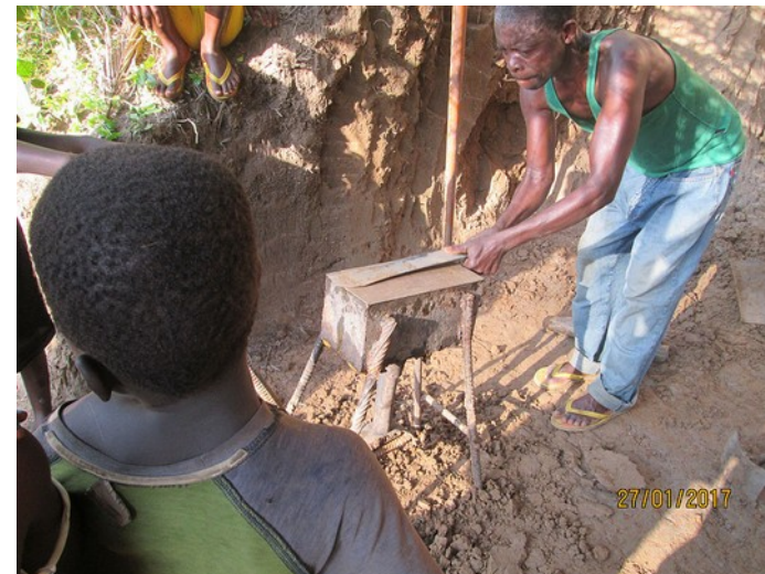
Pressage des briques de terre
